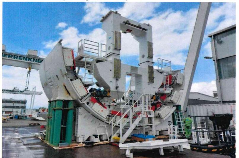
Bouclier du futur tunnelier en cours d'assemblage - Allemagne
